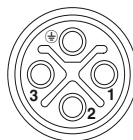
Схема контактов гнезда M12, 4-конт., с мех. ключом S, вид со стороны гнездовой части
